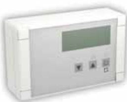
CT - Total Control Geschikt voor alle luchtgordijnen, van Optima tot MAX (uitgezonderd Minibel en ECO). Toepasbaar bij alle types (P/E/A). Extra functies: vorstbeveiliging, deurcontact, thermostat, etc... Tijdprogramma: 3x AAN/UIT keuzes voor elke dag van de week. Digitaal display met tijd, toerental, verwarmingstrap, huidige en ingestelde temperatuur. Meertalige display met 9 talen. Hand en automatische bediening met programmeerbaar gedrag.
